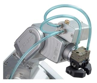
(d) connecting the pneumatic tubes
